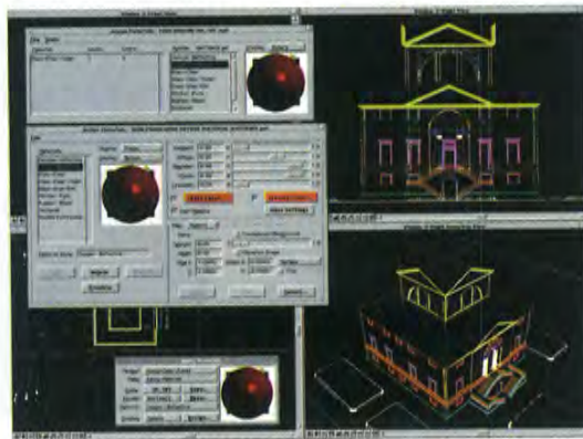
La definizione-editazione e l'assegnazione di texture avviene con differenti tools; questi sono ricchi di opzioni come tradizione nei programmi di rendering. È possibile vedere in anteprima le variazioni dei settaggi senza la necessità di assegnazione e successivo render.
