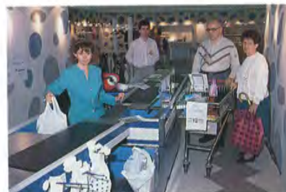
Cassa speciale a tre nastri, composta da un banco centrale predisposto per l'inserimento dello scanner, del cassetto basso per il pagamento frontale e della tastiera con visore
