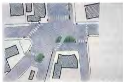
Nell'attesa che il PUT (Piano Urbano del Traffico) produca i suoi effetti è possibile rendere più sicuro l'attraversamento di questo complesso incrocio dell'Ospedaletto rialzando il tratto di carreggiata in modo da poter ridisegnare i confini (per proteggerli) tra gli spazi pedonali e meccanizzati.
