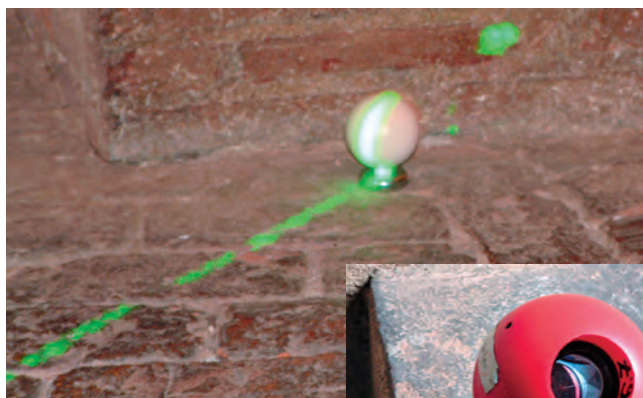
Target sferico con prisma. Perfettamente identico per forma e dimensioni al target sferico standard, questo modello permette di collegare la nuvola dei punti ad un rilievo topografico
