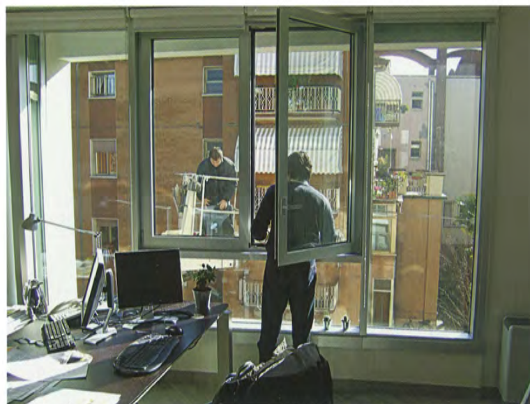
Una fase della misurazione della tenuta acustica delle vetrate
