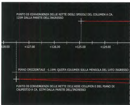
Punti di convergenza tra le facce laterali del column e tra la faccia inferiore del column ed il pavimento
