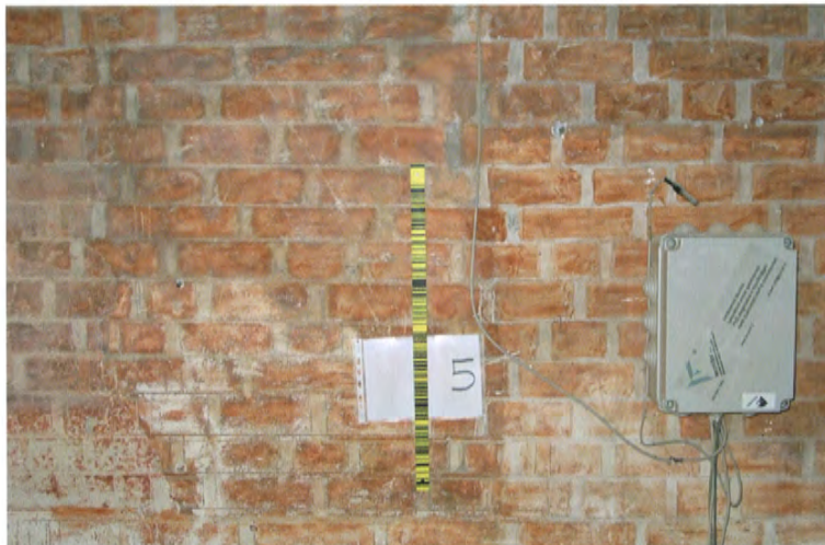
Una delle 8 barre Invar con codice a barre per la livellazione altimetrica a lettura elettronica posizionate sui vertici del campanile
