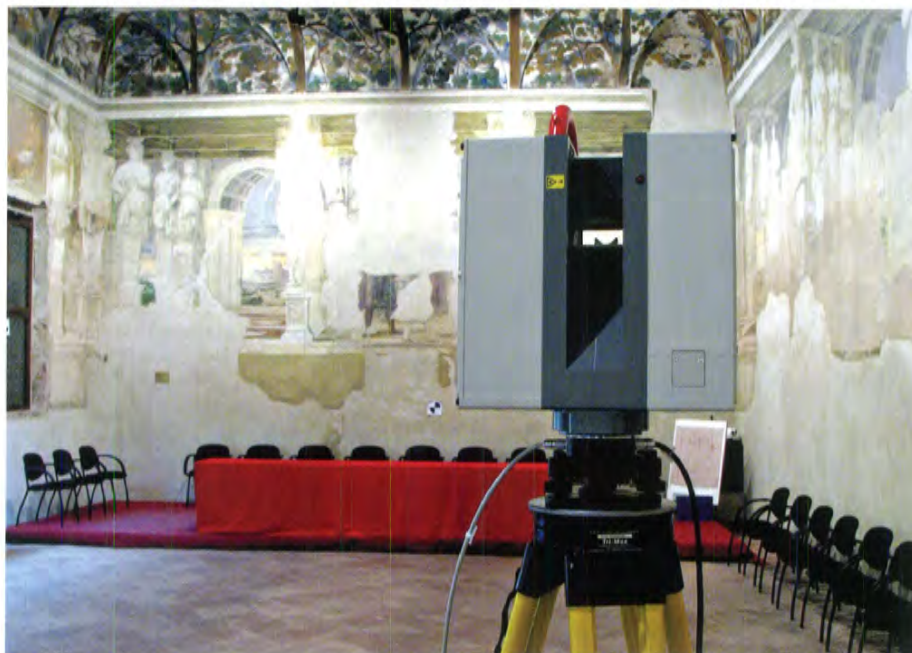
La testa del laser RADAR scanner HDS 6000 vista frontalmente
