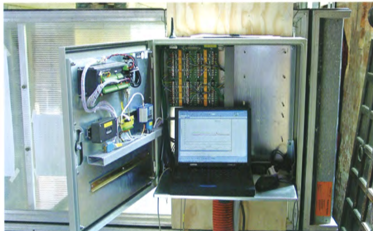
Centralina per la raccolta dei dati di inclinometri, estensimetri, piezometri
