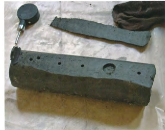
Particolare di prova taglio su campione di terreno prelevato per verificare gli aumenti di resistenza dopo tre cicli di iniezioni
