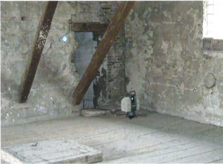
Fasi di acquisizione metrica con il Laser 3D Leica HDS 3000 degli ambienti interni
