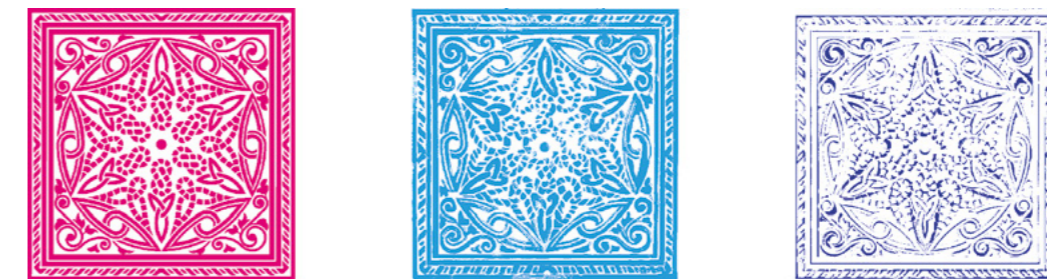
04. Confronto tra il disegno originale (in magenta), lo stato attuale ricavato dal fotopiano del rilievo fotogrammetrico (in ciano), e gli errori prodotti dai vari restauri (in blu).
